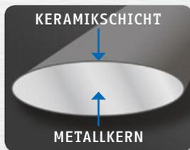
**Bruchfest** durch massiven Metallkern und **verschleissarm** durch eine extraharte keramische Oberfläche. Die extrem hochwertige Beschichtung erfolgt im Hochtemperatur-Flammspritzverfahren. Aufgrund der extraharten keramischen Oberfläche sind diese Wetzstähle besonders für das Schärfen von härteren/verschleissfesteren Messern geeignet.
